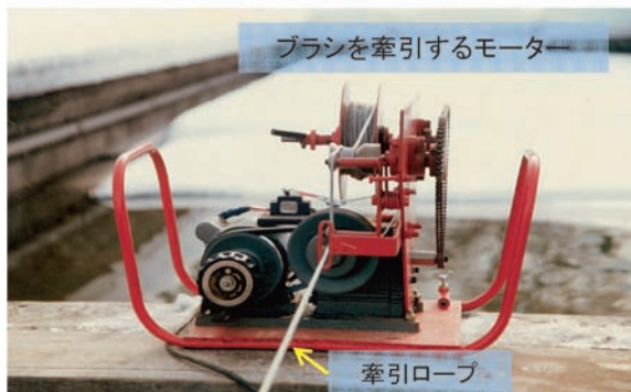
写真1. 試作した自動清掃機のブラシと牽引モーター
