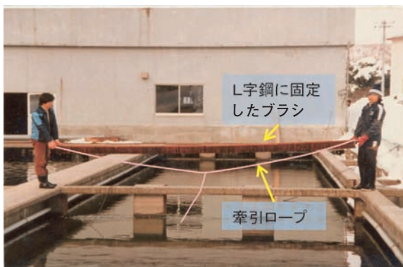
図8. 試作した自動清掃機の仕組み
