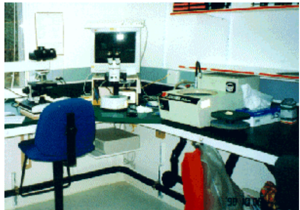
写真 2. 耳石標本の分析に用いる研磨機と顕微鏡(アラスカ州漁業狩猟局耳石研究室)。右上の棚にはパウチャー標本が収められている。
