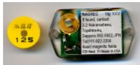
図2. ディスクタグ (左) とアーカイバルタグ (右)。
