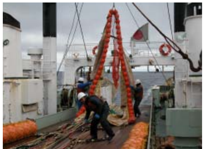
図2. トロール揚網作業 (トロールの開口部約25 x 25 m、曳網速度3.5-4.5ノット)。
