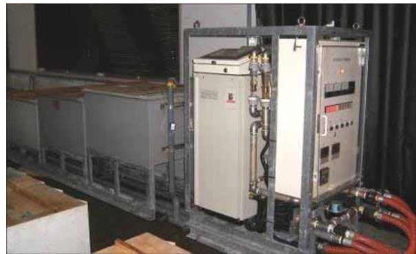
図4. 片岸川ふ化場に設置している耳石温度標識装置。ふ化槽に流れるふ化用水温を定期的に上下させることによって、槽内に収容している発眼卵の耳石に標識となる輪紋が形成される。
