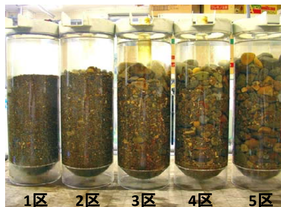
図1. サケ産卵床の礫組成と浮上までの生残率を実験した水槽。礫組成(Fredle指数)は; 1区(1.4)、2区(2.5)、3区(4.8)、4区(7.7)、5区(14.7)に設定。
