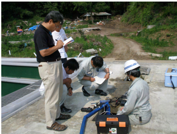
写真3. 井戸能力パイロット調査。平成23年6月29日、宮城県気仙沼市の本吉ふ化場で撮影。
