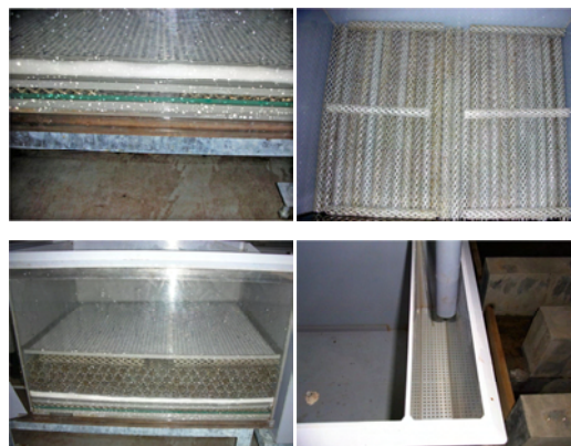
図 6. ふ化器のセッティング手順. 左上: 改良型下網を設置. 右上: 敷き詰めたネットリングと直交するように 30cm のネットリングを配置 (右側が排水部). 左下: 目合いの大きな下網を設置 (右側が排水部). 右下: 注水部へ設置した整流板.
