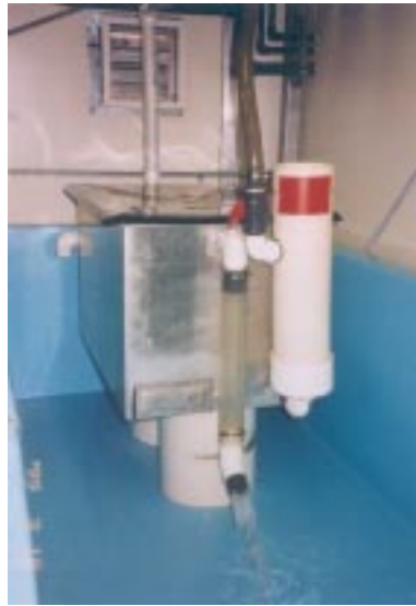
写真6. スネティシヤムふ化場で使用している孵化槽．隔離を目的とした孵化槽．親魚15尾分の受精卵を収容し，浮上まで管理できる．構造は小型の浮上槽で，浮上した稚魚は下部の水槽で1gサイズまで飼育される．
