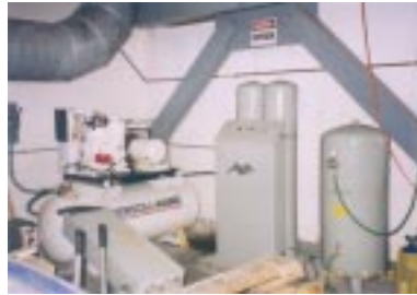
写真8. 酸素発生機。酸素を注入することにより、高密度の飼育が行われている。
