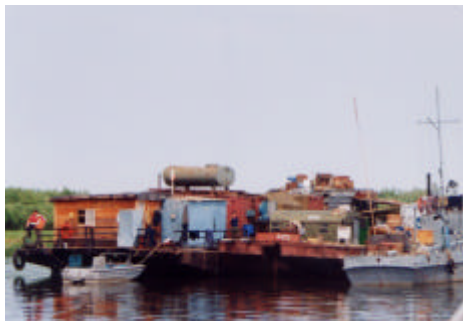
写真4. カイマン漁業会社のコンビナート。はしけの上に居住用のプレハブ、冷凍コンテナ、発電機、作業場などがあり、それ自体が移動可能な簡易加工場となっている。このコンビナートを拠点に、サケのそ上を追跡しながら漁業を行う。
