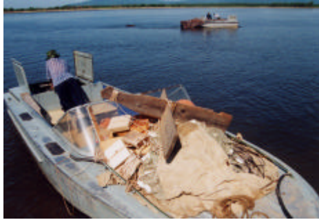
写真2. アムール川でサケの表層流網に用いられるモーターボートおよび漁具。 写真中央の木材を十字に組み合わせたものが抵抗板で、操業時に川の流れを受けて網を流下させる役目を担う。
