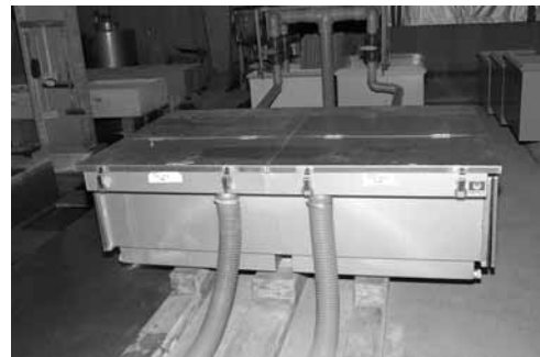
図4. 浮上槽. 受精後に卵を収容し, 浮上まで管理することが可能である.
