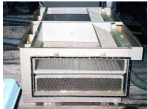
写真1. 本州型浮上槽の内部。通常は側面すべてがアルミ板で覆われている。
