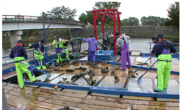
図 2. 千歳川のサケの捕獲施設 インディアン水車と呼ばれ、川をせき止めて水車でサケを捕獲する。
